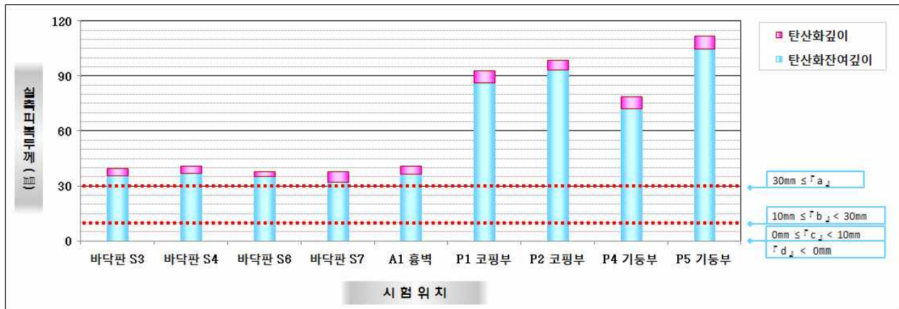
【그림 3.4.17】 탄산화 깊이 측정결과(부산)
