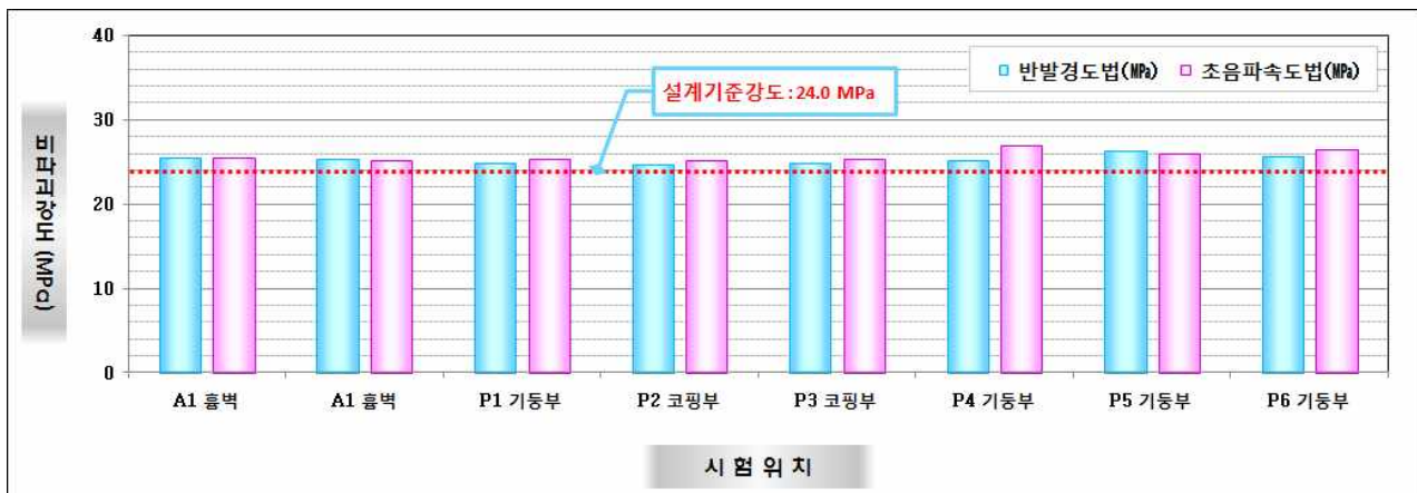
【그림 3.4.12】하부구조(교대, 교각) 평균압축강도 추정결과(대구)
